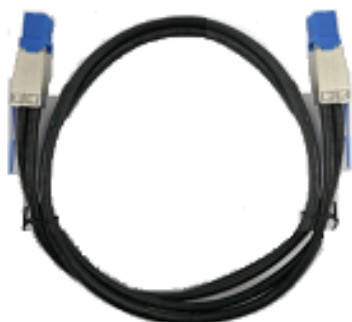
图4-34 安装防尘盖的 SAS 线缆示意图
