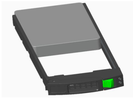
图3-25 2.5 英寸磁盘模块 B 外观
