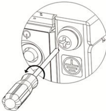
图4-23 松开设备接地端子的螺钉示意图
