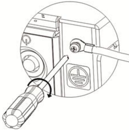
图4-24 安装接地线示意图
