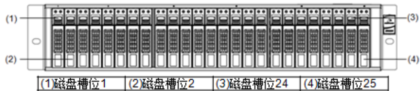
图6-19 DSU2725 磁盘槽位编号示意图
